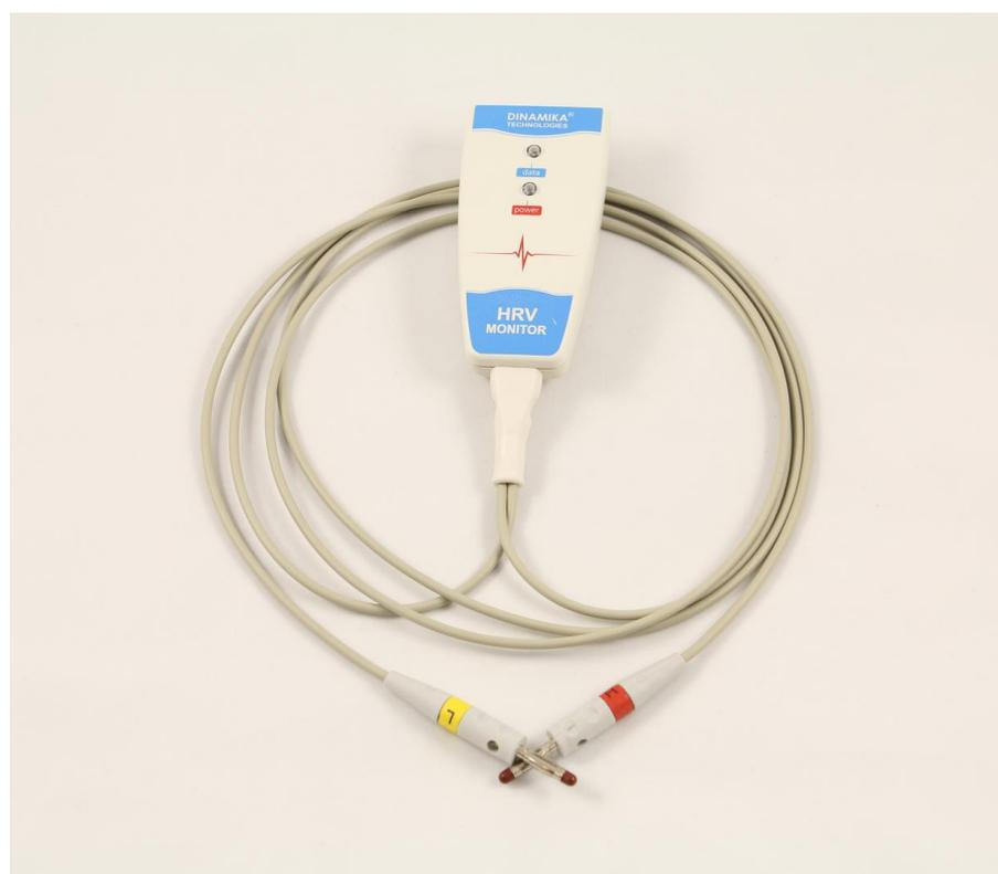
Si le câble d'électrodes est en bon état, alors le signal ECG sur l'écran doit rapidement prendre la forme d'une droite idéale lorsque les deux électrodes sont reliées. Au cours des premières secondes, cette ligne fluctue du haut vers le bas du graphique, mais elle se situe très rapidement au milieu du graphique de l'ECG et ne changera pas de forme tant que vous n'ouvrez pas les électrodes.
